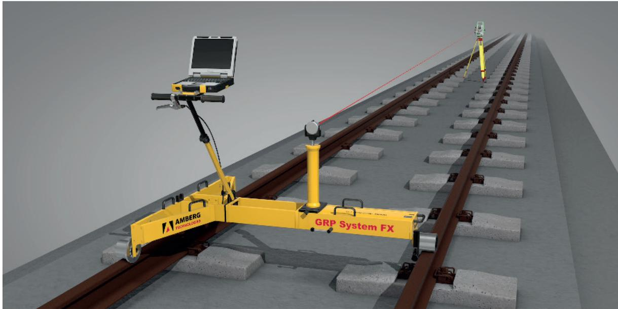
Solution de mesure intégrée, optimisée pour les besoins typiques durant la construction, l'inspection et la maintenance des voies rigides
