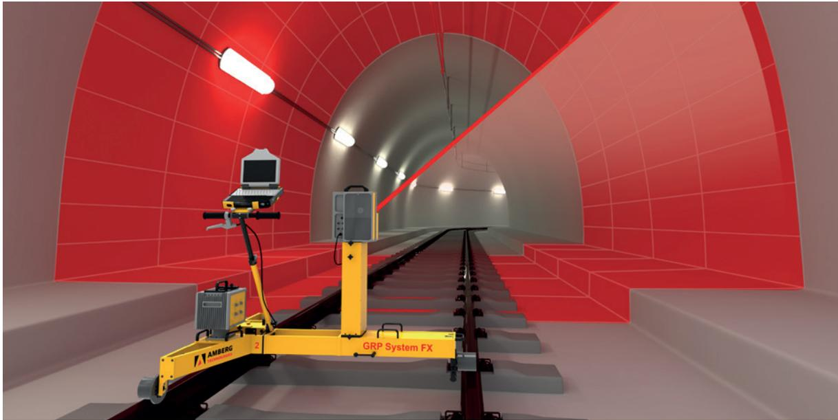
Solution système modulaire pour la mesure de gabarits manuelle et automatique notamment un outil performant d'analyse des gabarits statique et dynamique
